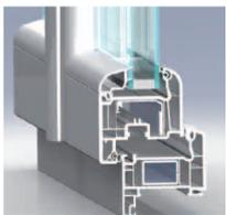
Dormant de 70 mm à 4 chambres aux parois de forte épaisseur offrant une résistance mécanique accrue. Vitrage 24 mm (4/16/4). Basse émissivité et gaz Argon de base.
